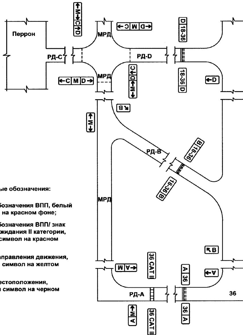
Рисунок 4. Пример расположения аэродромных знаков
