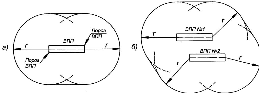
Рисунок 3. Внутренняя горизонтальная поверхность
