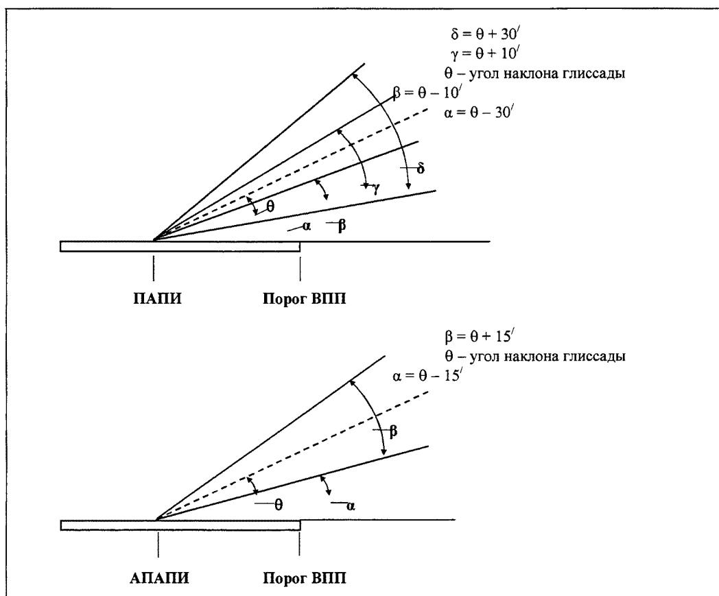
Рисунок 15. Углы возвышения огней в системах РАПИ и АРАПИ
