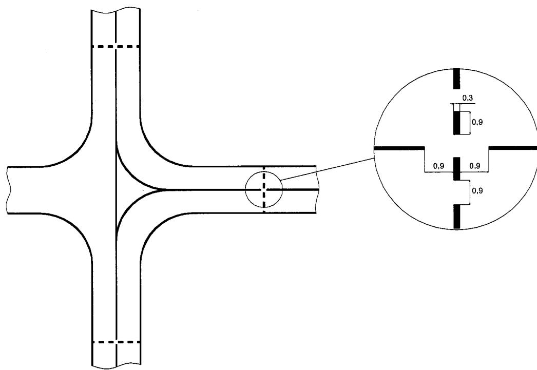
Рисунок 6. Схема маркировки промежуточного места ожидания
